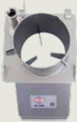
Einfüllzylinder A mit 3 internen Messern fixiert und trennt die Produkte während des Schneidvorganges. Der Einfüllzylinder A kann mit der pneumatischen Einfüllvorrichtung, der manuellen Einfüllvorrichtung und der 4-Rohr-Füllvorrichtung verwendet werden. Er ist besonders für die Verarbeitung von Kohl oder anderen großen Gemüsen geeignet.
